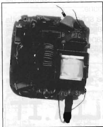
Foto 1 - Circuito elettronico trasformatore per lampade fluo compatte commerciali.
